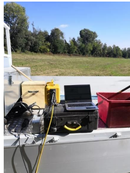
Attrezzatura per l'acquisizione del segnale sismico
