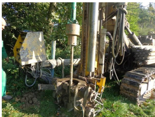
Esecuzione prova SPT
