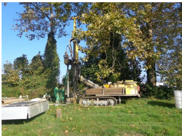
Esecuzione sondaggio a carotaggio continuo
